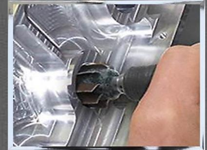
***Ce nouveaux modèle de roue monte sur un axe de Ø 2.35 mm, a été développé pour polir l'intérieur de bague, elle est aussi largement utilisé pour les cavités intérieures sur des pièces industrielles difficilement accessibles, sa capacité à s'adapter à différents diamètres font de ce produit innovant un outil formidable et efficace pour réduire votre temps de travail et processus.***
